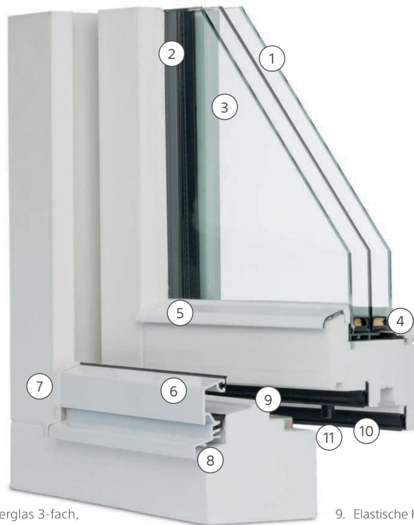
1. Wärmeschutzisoliertes 3-fach, Ug 0.5 bis 0.7 W/m<sup>2</sup>K mit Argongas, Uw-Wert bis 0.79 W/m<sup>2</sup>K
